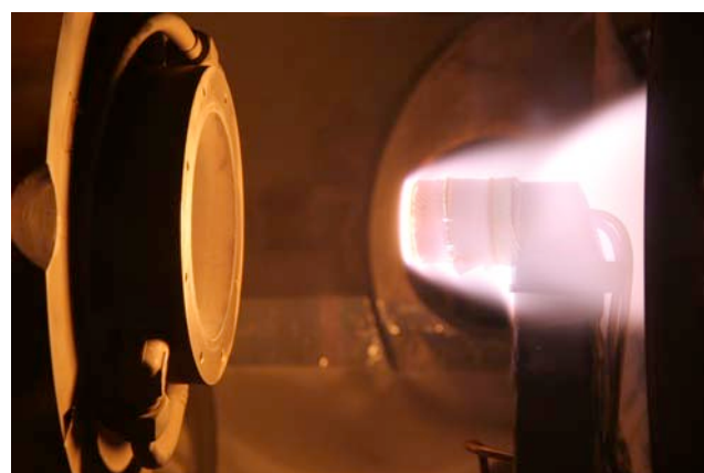
図 3 加熱試験の様子 (供試体 H1A2-1 加熱開始約 50 秒後)
