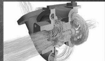
流体・固体連成解析でのターボチャージャー内の高/低温流路の流線
