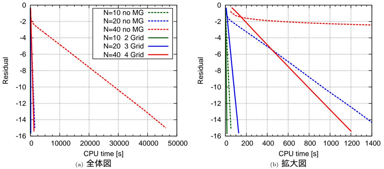
Fig. 4:  $h$ -MG を用いた計算の CPU time と残差の関係
