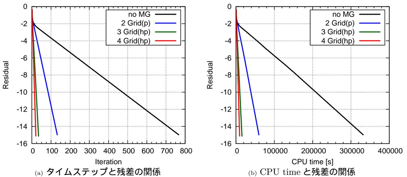
Fig. 5:  $hp$ -MG を用いた計算の収束履歴
