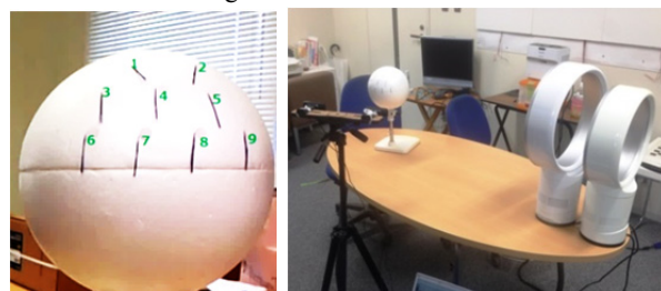
Fig.1 タフト法を用いた流れ方向の計測実験
