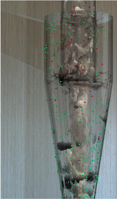
Fig. 2: ダストが流れ始めてからの時間  $t = 13.8$  ms の際の  $Q$  の等値面による渦構造とダストの位置 (赤色は最終的に捕集できなかった粒子で緑色が捕集される粒子を表す)
