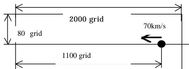
図(1) 流星の大気突入シミュレーションの設定
