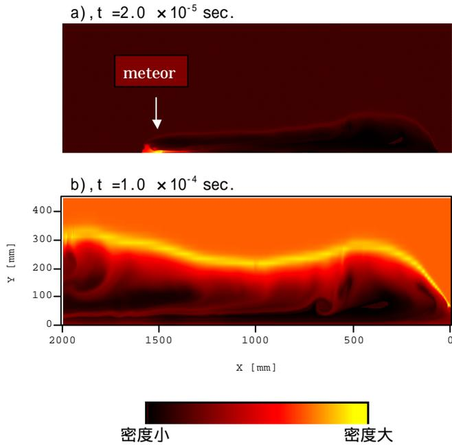
図(2)：密度分布の変化 上から a), t=2.0×10<sup>-5</sup>s b), t=1.0×10<sup>-4</sup>s における密度分布を示す。
