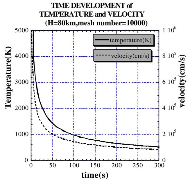
図(6) : 高度  $80$  km、初期流速  $10$  km/s、初期サイズ  $2$  m での最大流速、最大温度の時間発展の様子
