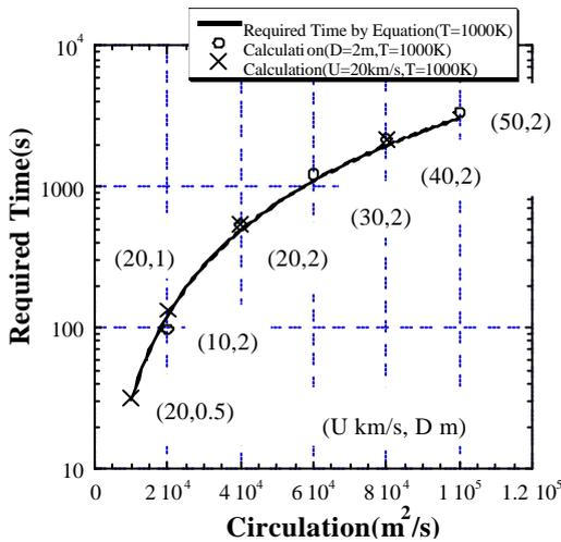
図(7) : 循環値(流速UとサイズDの積)と継続時間の関係
